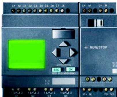
Rys.1. Wygląd zewnętrzny sterownika (do montażu na szynie DIN 35 mm)
