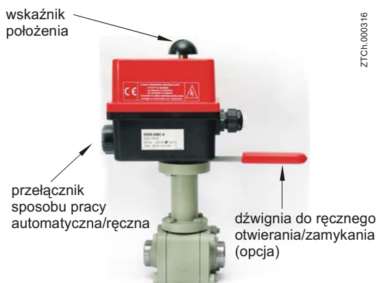
Rys. 1. Zawór kulowy silnikowy YLDSV z dźwignią do ręcznego otwierania/zamykania, DN 40 mm
