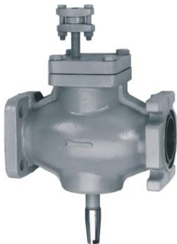
HCK2 - zawór odcinający ssawny uruchamiany parowo (gorącym gazem), z przyłączami kołnierzowymi
