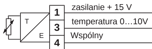
Schematy połączeń modeli aktywnych 0...10V
