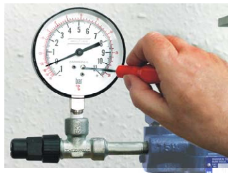
Rys. 3. Korygowanie położenia zerowego manometru za pomocą śrubokręta i wkręta regulacyjnego
