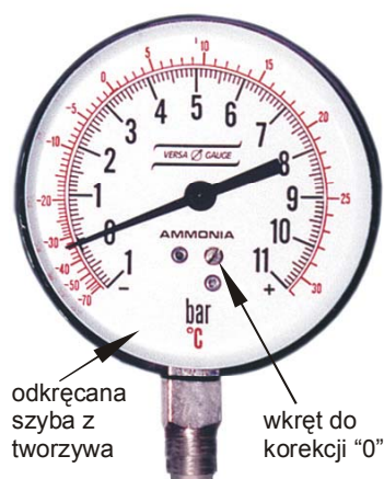
Rys.1. Manometr amoniakalny GA1M o zakresie -1 do 11 bar
